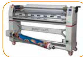
Le mandrin avant pivote pour faciliter le chargement des vinyles
